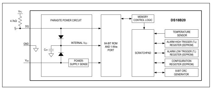
Figure 3. DS18B20 Block Diagram
