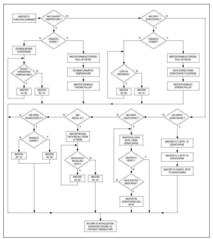
Figure 14. DS18B20 Function Commands Flowchart
